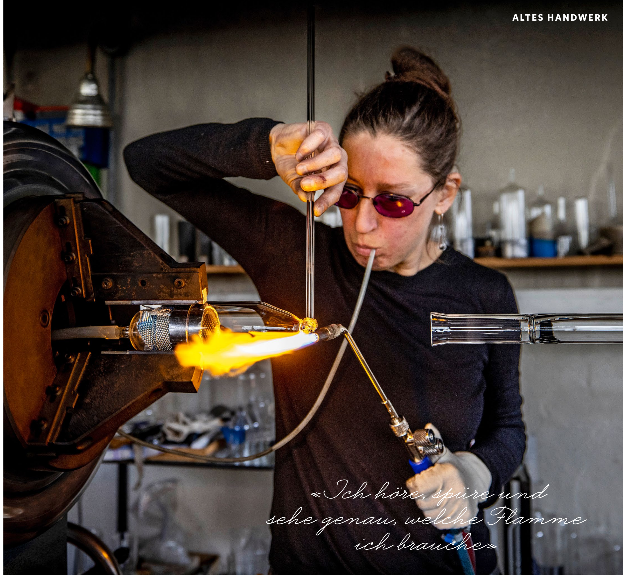
Mit viel Gespür für die optimale Hitze und Luftzufuhr: Durch das Gummischläuchlein bläst Rahel Koller Luft ins offene Ende des Glasrohrs.
